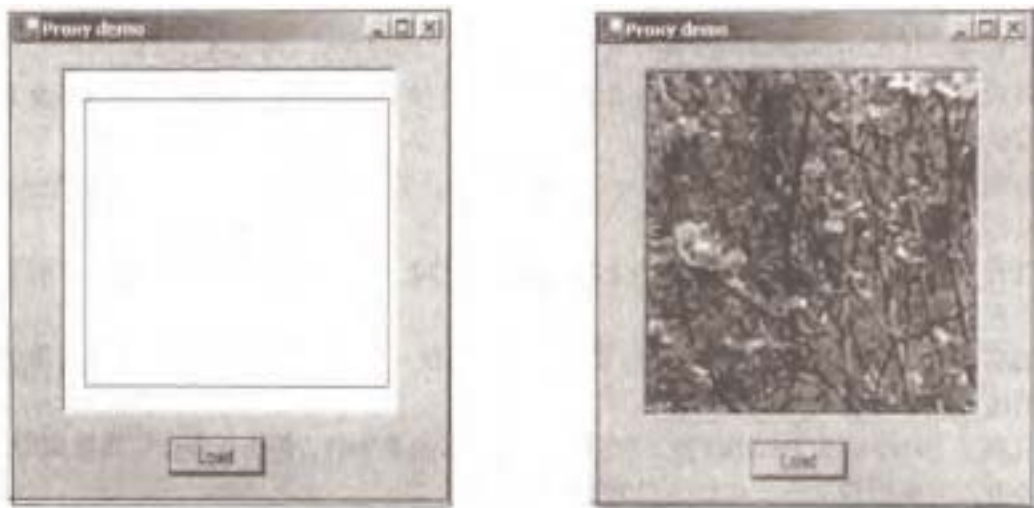
图 20.1 左图显示代理图像直到图像调入完毕,右图显示的是实际图像
